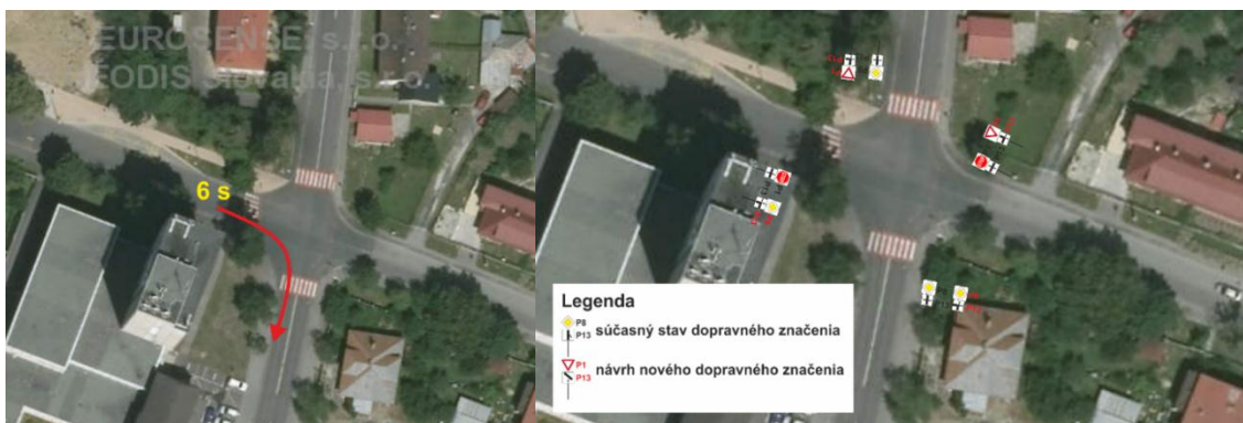
Obr. 5 Zdržanie vozidiel MHD na vjazde do križovatky (vľavo), návrh zmeny organizácie dopravy predefinovaním vedenia hlavnej komunikácie na ul. Levočská – Okružná (vpravo) Zdroj:[8]
