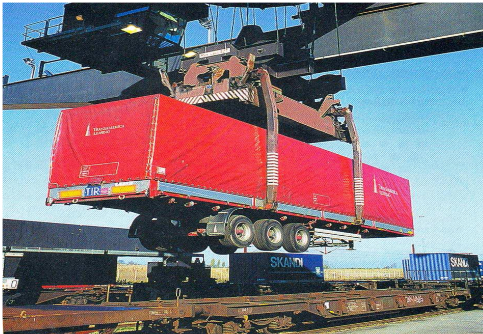
Obr. 1: Prekládka návesu na špeciálny vagón
