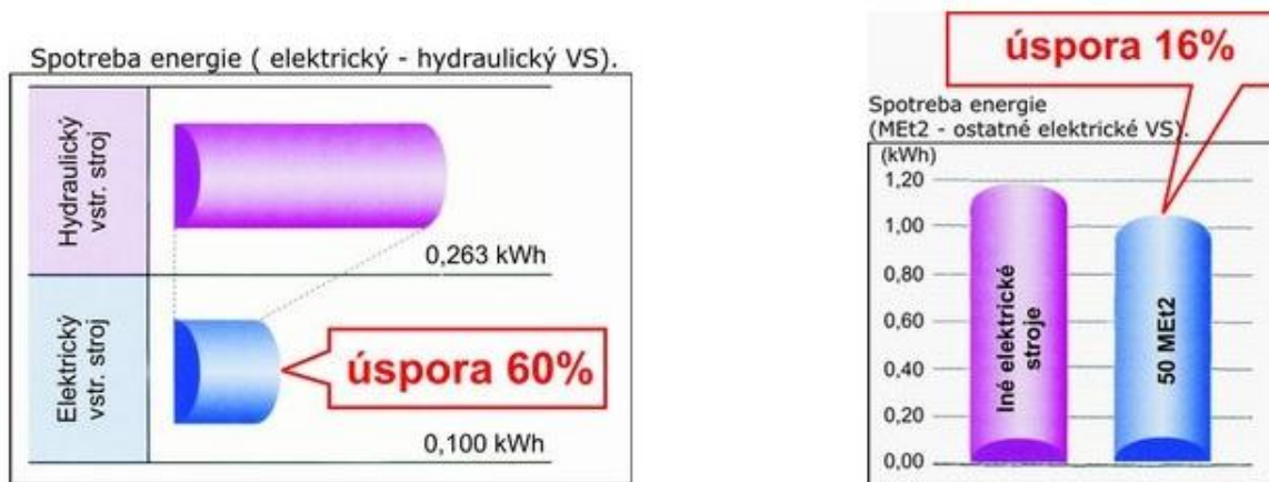
Obr. 3) Porovnanie spotreby energie hydraulického a elektrického vstrekovacieho stroja. [3]
