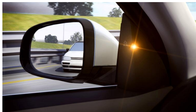
Obr.2 Výstražná kontrolka upozorňujúca vodiča na vozidla v mŕtvom uhle Zdroj: http://www.carexpo.info
